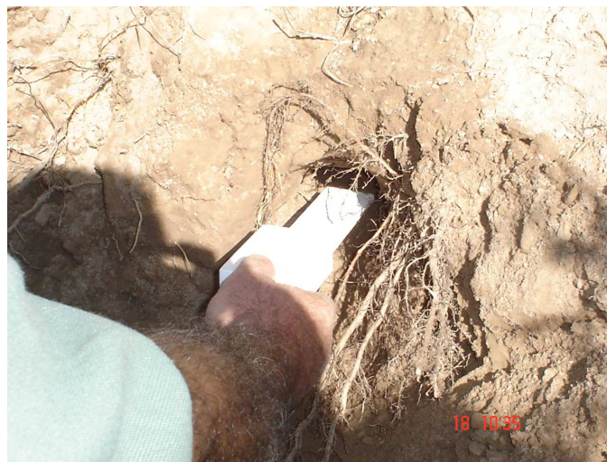
Fotografía 3. Orificio en la zona de las raíces apropiado para la inserción del sensor. Se aprecia también el sensor de color blanco.
